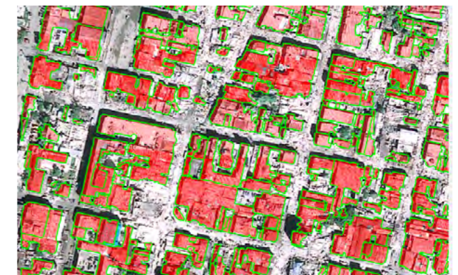
Detección de edificios en Puerto Príncipe, Haití, mediante el análisis de puntos LiDAR, tras el terremoto de 2010. Forma parte del proyecto de investigación de la Tesis Doctoral.
